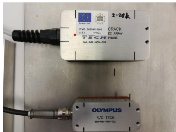
Obrázok 6: Sondy vírivých prúdov ECA značky Olympus (Zdroj: Autori).
