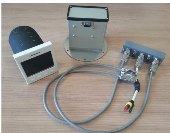
Obrázek 7 – Komponenty systému prototypu laserového výškoměru (zobrazovací jednotka, sensor, datová sběrnice)
