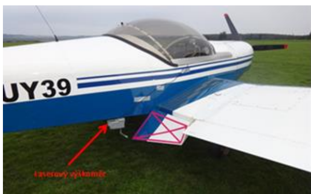
Obrázek 4 – Zkušební instalace laserového výškoměru
